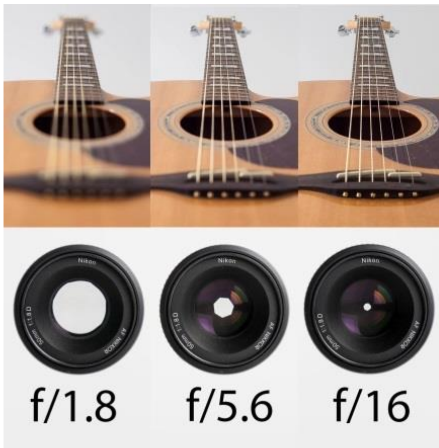
Kadra asuma dziļums pie dažādiem relatīvajiem objektīva atvērumiem ( Damien Fournier Photography )
